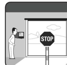
PORTE S'ARRETE sur le fin de course haut
