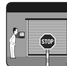
PORTE S'ARRETE sur le fin de course bas
