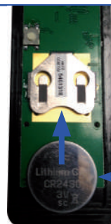
3 - Monter la pile de remplacement.
