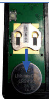
2 - Démontez la pile défectueuse
