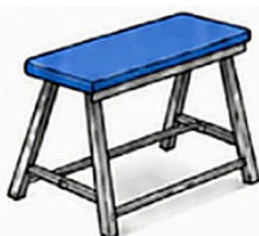
Support protégé pour dépose du vitrage
