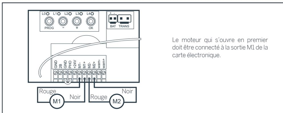
Le moteur qui s'ouvre en premier doit être connecté à la sortie M1 de la carte électronique.
