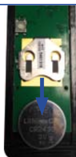
2 - Démontez la pile défectueuse
