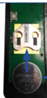
3 - Monter la pile de remplacement.
