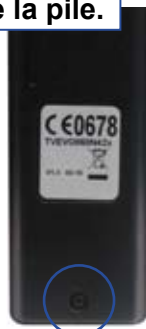
1 - Dévisser la vis au dos de l'émetteur.
